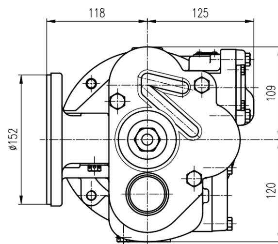
A \_Hauptluftleitung      C \_Bremszylinder
